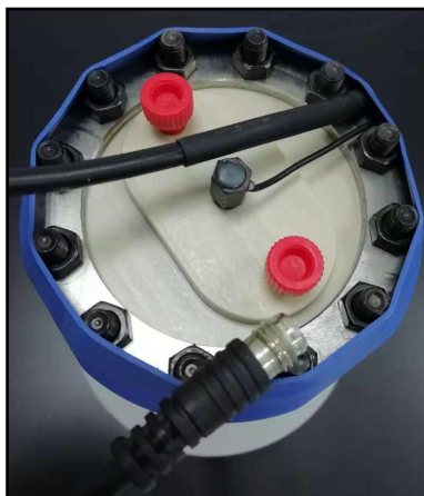
图 6-8 淋洗液发生罐堵头及电缆
