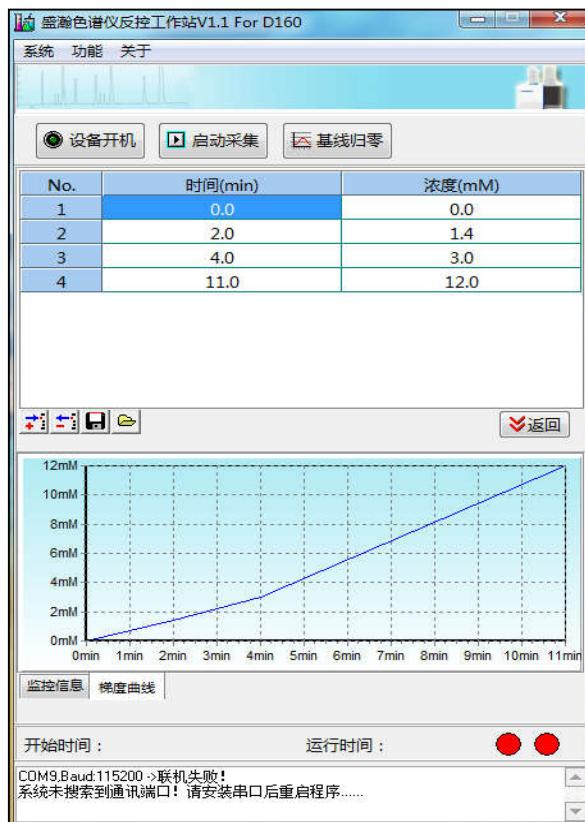
图 3-27 淋洗液发生器梯度曲线
