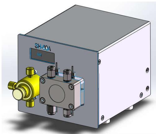
图 1-2 微型高压恒流泵
