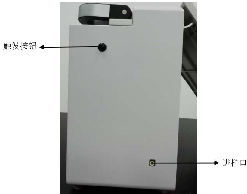
图1-2 仪器侧面外观示意图
