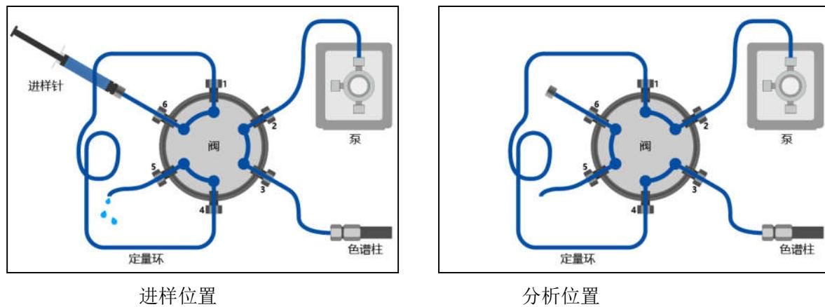
图 1-4 六通手动进样阀工作原理
