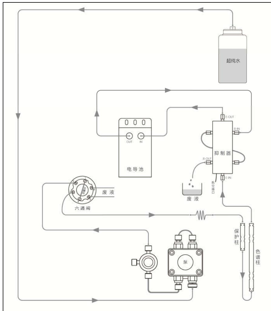
图 1-6 色谱仪流路连接示意图
