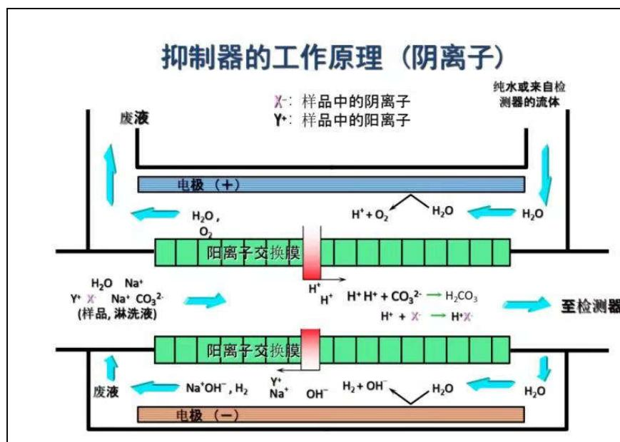
图 1-5 抑制剂工作原理示意图
