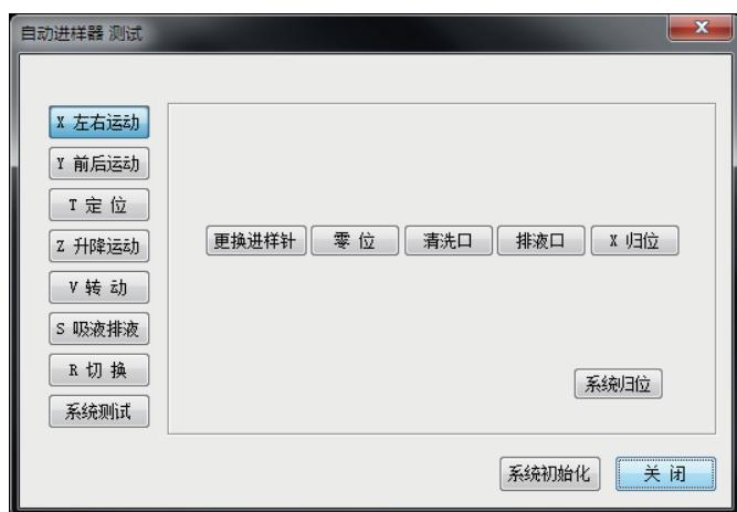
SHA-12/SHA-15自动进样器可控部件包括：移动小车，托盘托架单元，取样针，计量泵单元，进样阀等。
