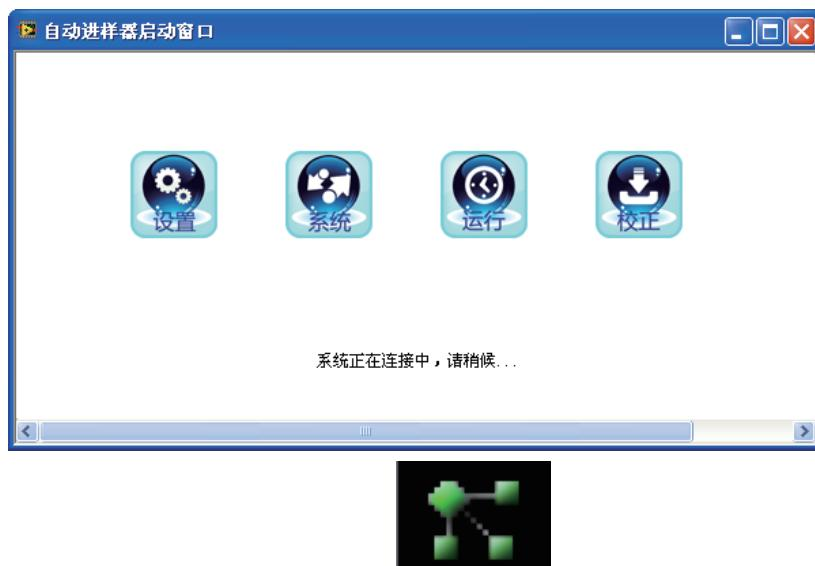
仪器进入待机状态后，双击桌面“**SHA-12/SHA-15自动进样器 服务软件**”图标，打开 SHA-12/SHA-15 自动进样器 服务软件，软件自动与 SHA-12/SHA-15 自动进样器连接，窗口下端状态显示“系统正在连接中，请稍候 ...”。如果连接正常，状态行显示“系统连接成功”，如果连接不成功，将提示“连接中断，请检查！”。如果确认已连接好，可重新打开工作站。
