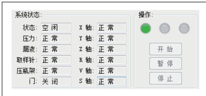
正常状态时，绿色指示灯亮，系统处于待机状态，系统正常；如果出现故障，指示灯亮红色。指示灯为黄色，表明当前正在进行取样工作。
